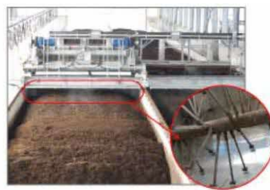
○攪拌機(かくはん機) 24時間稼働で、完成までに40回の攪拌を行います。
