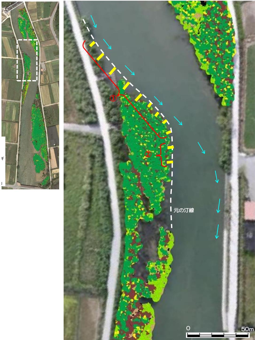
図 1.2.1-10 (2) 右岸上流における水制工の配置イメージ
