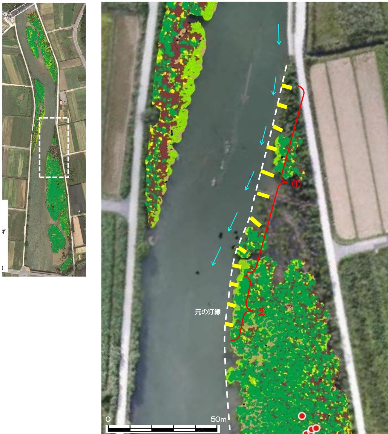
図 1.2.1-10 (3) 左岸中流における水制工の配置イメージ
