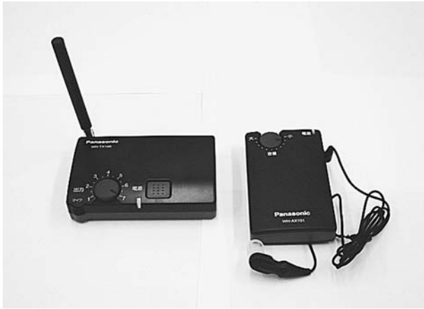
▲町立中央公民館で使用している赤外線補聴システム
